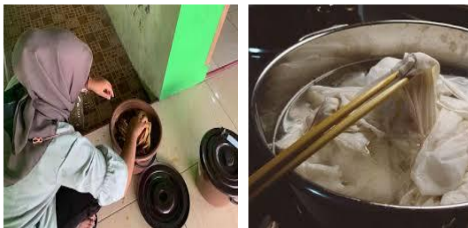
Gambar 3. Proses Perendaman Kain Tote Bag dengan Air Tawas
